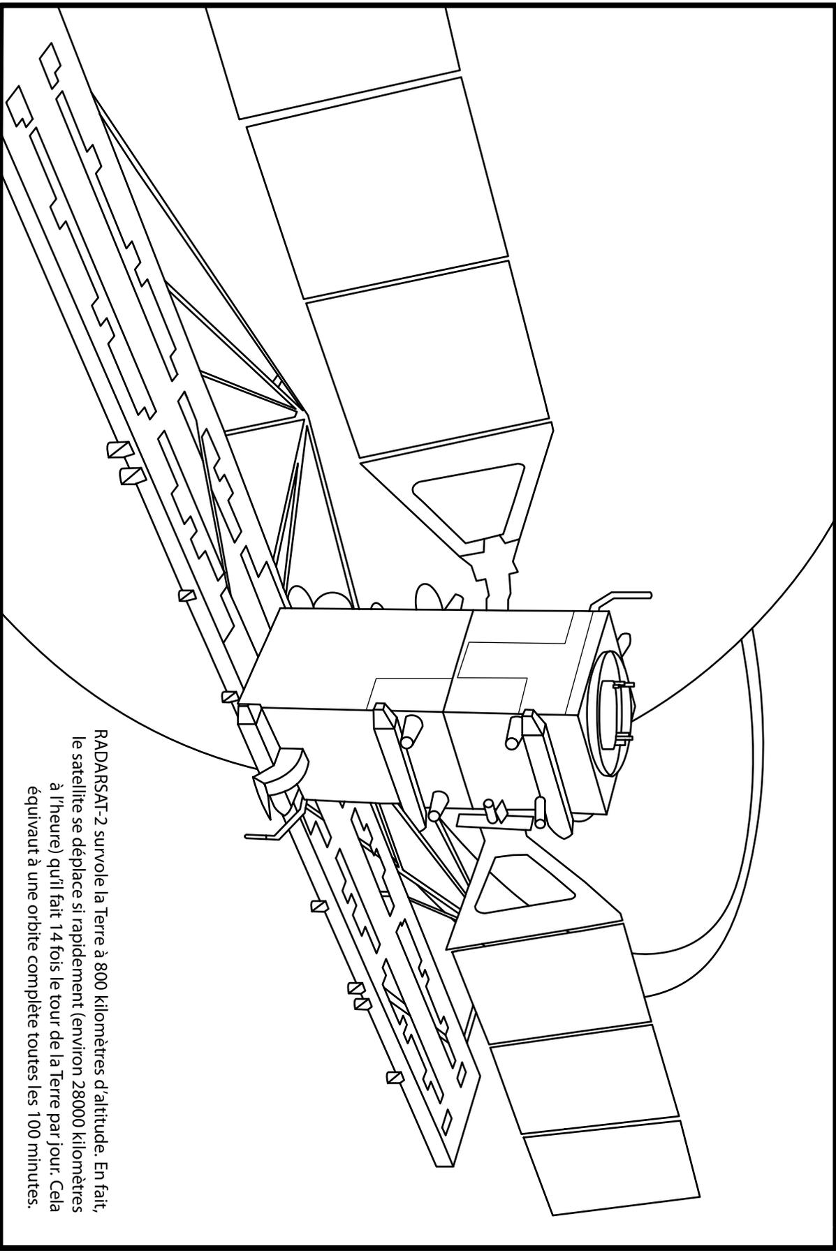
RADARSAT-2 survole la Terre à 800 kilomètres d'altitude. En fait, le satellite se déplace si rapidement (environ 28000 kilomètres à l'heure) qu'il fait 14 fois le tour de la Terre par jour. Cela équivaut à une orbite complète toutes les 100 minutes.
